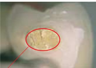
Sección transversal **incorrecta** de la estructura de metal de 1.5 x 2.5 mm = 3.75 mm<sup>2</sup> – dimensión vertical sólo 1.5 mm en la dirección de flexión!
