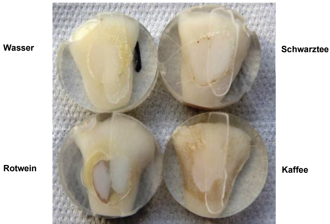
Abb. 15: Verfärbungstest mit Fluor Protector S: Nach 5 Minuten Lagerung in Wasser – Schwarztee – Kaffee – Rotwein (im Uhrzeigersinn, beginnend von oben links) ist keine Verfärbung der Lackschicht zu erkennen. Bei dem Prüfkörper „Rotwein“ waren im unbehandelten Schmelz Fehlstellen, welche sich etwas verfärbten.
