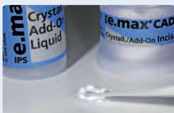
Mezclar IPS e.max CAD Crystall./Add On con líquido IPS e.max CAD Crystall./Add-On hasta obtener una consistencia dúctil.
