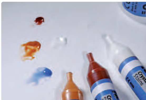
Extraer IPS e.max CAD Crystall./Shades y Stains de la jeringa y homogeneizar. Si fuera necesario, se diluye con líquido IPS e.max CAD Crystall./Glaze Liquid.
