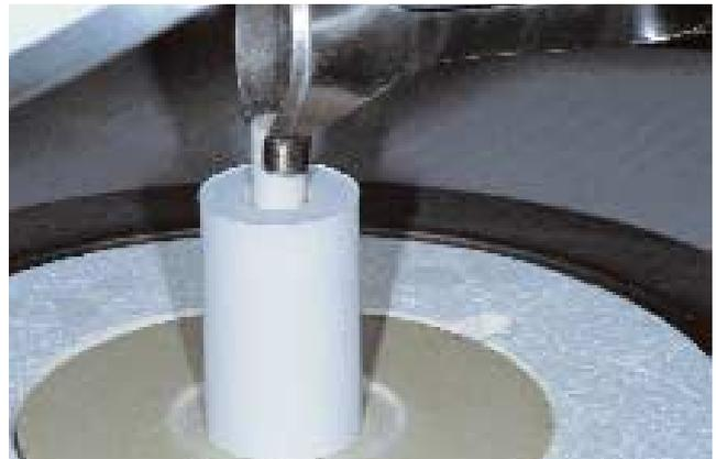
Introducción del pistón de óxido de aluminio pre calentado en el cilindro
