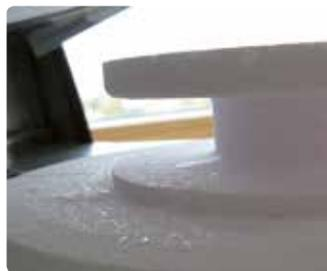
Der Sintertisch muss ebenfalls in regelmäßigen Abständen auf Staubfreiheit überprüft und ggf. entstaubt werden. Kontaktreaktionen können bei den hohen Temperaturen zu Schäden der Zirkoniumoxid-Oberfläche führen. Ersichtlich sind diese z.B. durch weisse Punkte.
