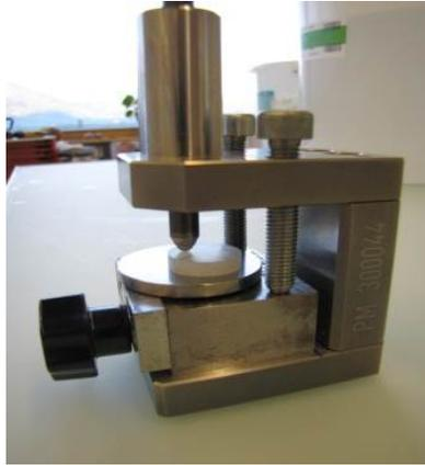
Abb 9a: Versuchsaufbau für den Rissinitiiertest.
