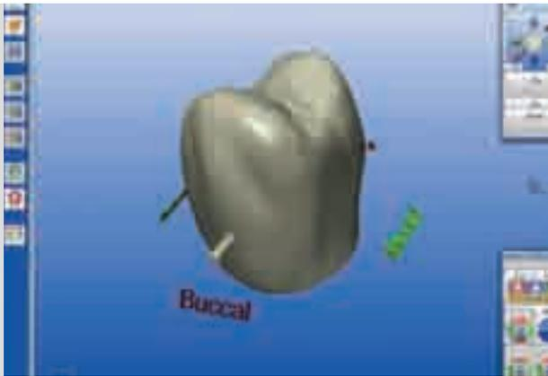
Fig. 5 Configuración virtual de la corona. La ilustración muestra el "modelado" del dispositivo provisional a ser fabricado mediante el software biogénico (CEREC).
