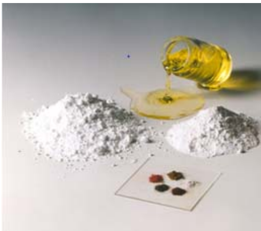
Abb. 1: Komponenten eines typischen Composites: Monomermischung, Füller, Initiatoren, Katalysatoren und Pigmente.
