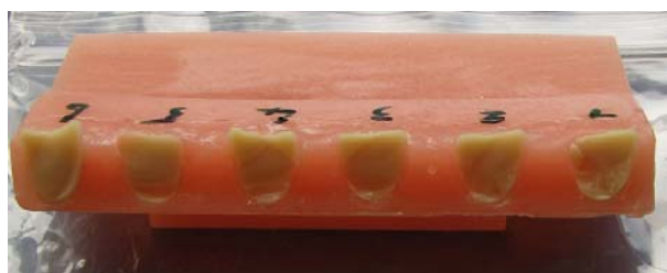
Abb. 8a: Zahnverbund von SR Vivodent DCL-Zähnen zu Ivobase Hybrid. Prüfung gemäß EN ISO 22112. Interne Messung, Ivoclar Vivadent.
