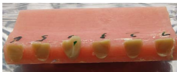
Abb. 8b: Zahnverbund von SR Vivodent DCL-Zähnen zu Ivobase High Impact. Prüfung gemäß EN ISO 22112. Interne Messung, Ivoclar Vivadent.
