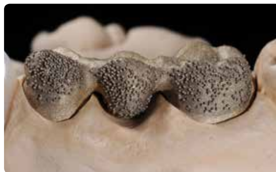
Vorsichtig ausbetten, abstrahlen bzw. absäuern und aufs Modell aufpassen.
