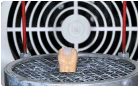
SR Gel deckend aber nicht zu dick auftragen und Stümpfe auf dem Objektträger fixieren und in die richtige Position bringen.
