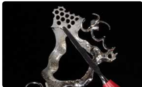
Retentionen sorgfältig mit \text{Al}_2\text{O}_3 (80–100 \mu\text{m} ) und mit 3 bar Druck sandstrahlen, die Reste mit einem Instrument durch vorsichtiges Abklopfen entfernen.
