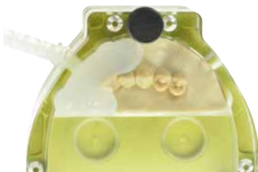
Die Küvette wird mit dem Klarsilikon Transil F befüllt
