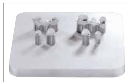
CAD/CAM-gefertigtes Gerüst (Lasersinterverfahren)
