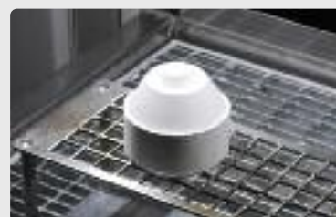
Una vez finalizado el programa de inyección coloque el cilindro de revestimiento sobre la rejilla de enfriamiento con las pinzas y deje que se enfríe hasta alcanzar temperatura ambiente.
