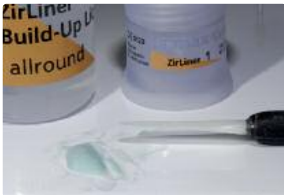
Mezcle el correspondiente ZirLiner con IPS e.max Ceram ZirLiner Liquid hasta obtener una consistencia cremosa.
