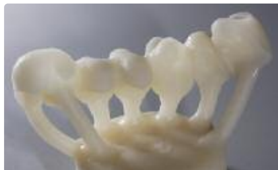
La eliminación basta se realiza con pulidores a una presión de 4 bar hasta que el objeto se hace visible. Utilice 2 bar de presión para la eliminación fina.
