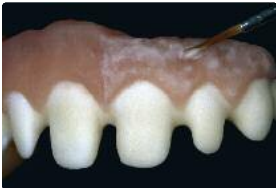
La cocción de preparación (wash) se realiza con IPS e.max Ceram Deep Dentin o Dentin sobre las áreas estéticas e IPS e.max Ceram Gingiva sobre las porciones gingivales. Tenga en cuenta el control de cocción j.
