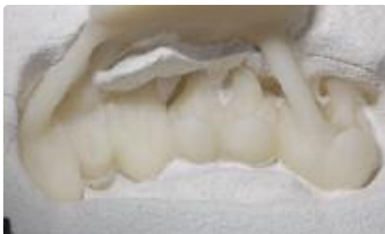
La eliminación basta se realiza con pulidores a una presión de 4 bar hasta que el objeto se hace visible. Utilice 2 bar de presión para la eliminación fina.
