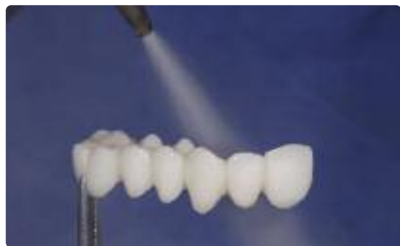
Antes del maquillaje y caracterización, limpie a fondo la restauración bajo agua corriente con pistola de vapor.
