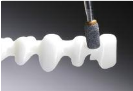
Utilice instrumental de repasado especialmente desarrollado para ZrO_2 para las modificaciones requeridas.
