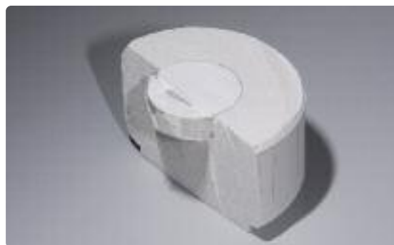
Separe el cilindro de revestimiento de 300 g, incluido el One-way plunger en las marcas, utilizando un disco de separación. Con los cilindros de 100 g y 200 g, separe en las marcas a la altura del pistón IPS Alox.
