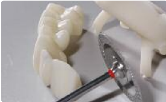
Utilice un disco de separar y refrigeración continua con agua para cortar los canales de inyección.
