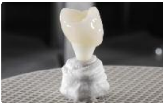
Realice la cocción de maquillaje y caracterización sobre una plataforma de cocción, aplicando los parámetros de cocción indicados.
