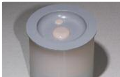
Permita que el cilindro de revestimiento fragüe sin manipularlo.
