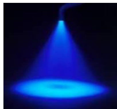
Abb. 8c: Homogene Lichtstreuung eines parallelen Lichtleiters
