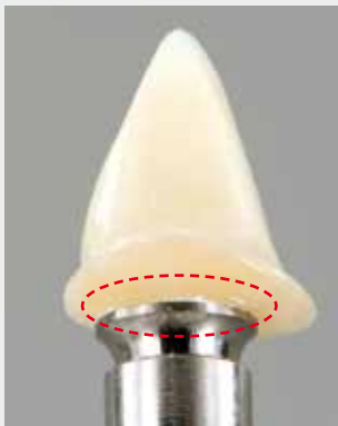
Wichtig: Um einen glatten Übergang zwischen der Viteo Base und der Keramikstruktur zu erreichen, muss die zirkuläre Stufe vorsichtig mit Gummipolierern unter leichtem Druck auslaufend poliert werden. Überhitzung vermeiden.
