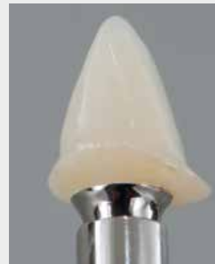
Wichtig: Um einen glatten Übergang zwischen der Viteo Base und der Keramikstruktur zu erreichen, muss die zirkuläre Stufe vorsichtig mit Gummipolierern unter leichtem Druck auslaufend poliert werden. Überhitzung vermeiden.
