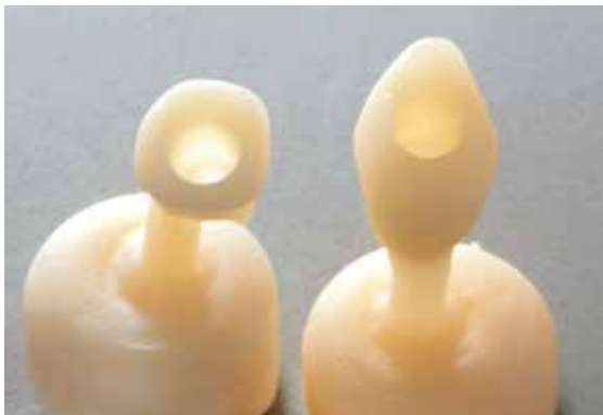
Schraubenkanal auf Bläschen kontrollieren...
