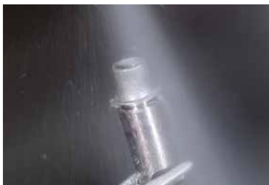
Reinigung mittels Instrument und Dampfstrahler. Unbedingt darauf achten, dass das gesamte Wachs gründlich entfernt ist
