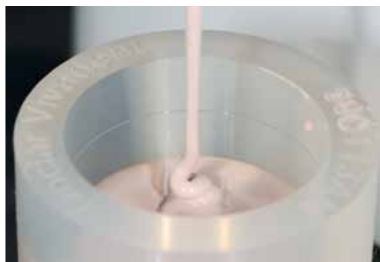
Die Einbettmasse langsam in die Muffel einfüllen, so dass diese im Schraubenkanal kontinuierlich aufsteigen kann.
