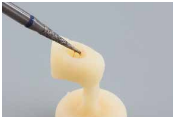
... welche mittels geeigneter Schleifkörper vorsichtig entfernt werden.
