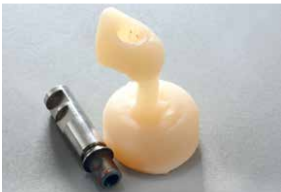
Eventuelle Störstellen mit der Titanklebebasis erzeugen am Pressobjekt im Schraubenkanal Markierungen...
