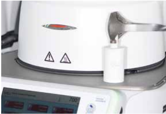
Anschließend den mit Separator benetzten IPS Alox-Kolben in die heisse Muffel geben.
