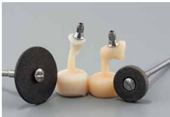
Abtrennen der Presskanäle mit einer Trennscheibe. Überhitzung vermeiden.
