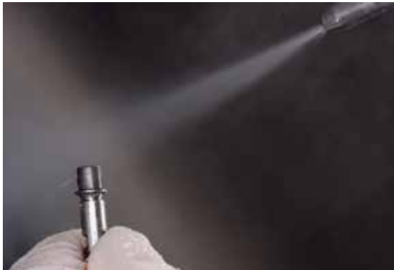
Reinigung mittels Ultraschallbad oder Dampfstrahler und anschliessend trocken blasen.
