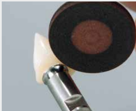
Wichtig: Um einen glatten Übergang zwischen der Viteo Base und der Keramikstruktur zu erreichen, muss die zirkuläre Stufe vorsichtig mit Gummipolierern unter leichtem Druck auslaufend poliert werden. Überhitzung vermeiden.
