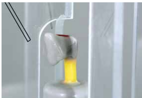
Ausrichtung der Modellation auf der Muffelbasis, sodass der Schraubenkanal parallel zur Aussenwandung der Muffel steht. Hierdurch kann nachfolgend ein gleichmässiges, kontrolliertes Einfüllen der Einbettmasse erreicht werden. Zusätzlich wird das Risiko des Abbrechens der Einbettmasse im Schraubenkanal beim Einpressen der Keramik verringert.
