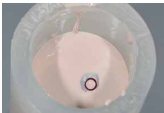
Die Einbettmasse langsam in die Muffel einfüllen, so dass diese im Schraubenkanal kontinuierlich aufsteigen kann.
