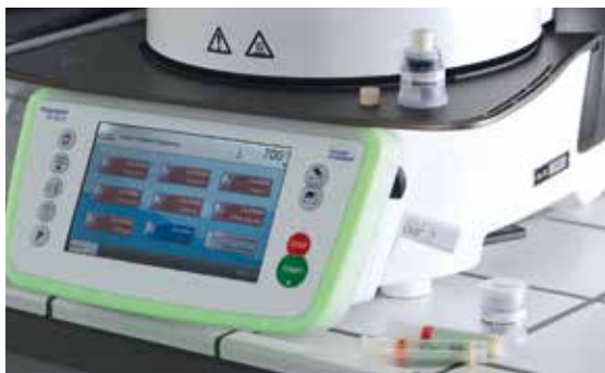
Kalten isolierten IPS Alox-Kolben und kalten IPS e.max Press-Rohling in der gewünschten Farbe bereitstellen.
