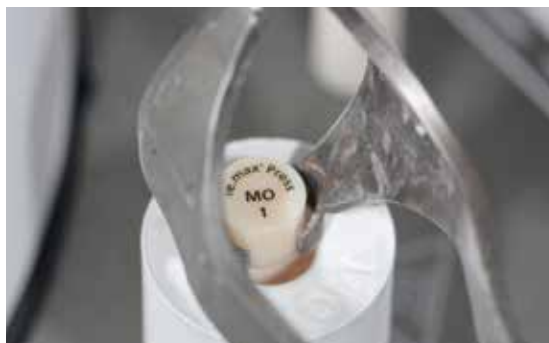
Kalten IPS e.max Press-Rohling mit der Rohlingsfarbe nach oben in die heisse Muffel geben.
