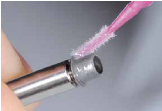
Monobond Plus auf die gereinigte Klebefläche auftragen und 60 Sekunden einwirken lassen. Nach der Einwirkzeit den verbleibenden Überschuss mit wasser-/ölfreier Luft trocken blasen.
