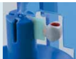
Ausrichtung der Modellation auf der Muffelbasis, sodass der Schraubenkanal parallel zur Aussenwandung der Muffel steht. Hierdurch kann nachfolgend ein gleichmässiges, kontrolliertes Einfüllen der Einbettmasse erreicht werden. Zusätzlich wird das Risiko des Abbrechens der Einbettmasse im Schraubenkanal beim Einpressen der Keramik verringert.
