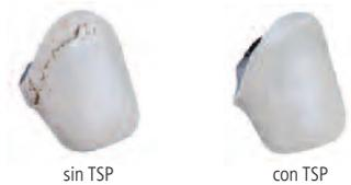
La función TSP (Protección frente al choque térmico) protege a la cerámica frente al choque térmico, si el cabezal del horno se cierra a una temperatura demasiado elevada.
