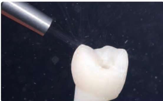
Abstrahlen des überpresstem IPS e.max ZirPress mit \text{Al}_2\text{O}_3 mit 1 bar Druck mit eingeschraubter Polierhilfe
