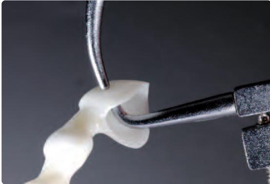
Gerüststärke inklusive aufgebranntem Liner messen und notieren.
