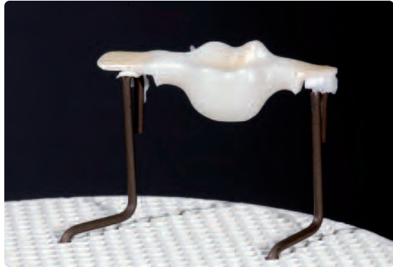
Zum Brand Positionierung des Gerüsts auf Metallpins Wabenträger (Metallpins) mit Hilfe von IPS Object Fix Flow.
