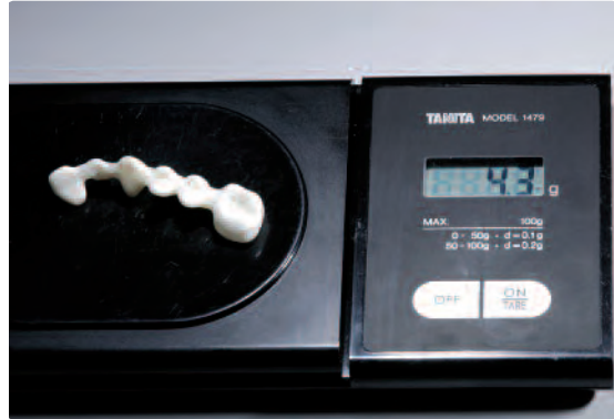
ZirCAD Gerüst mit aufgebranntem ZirLiner abwägen und Gewicht notieren.
