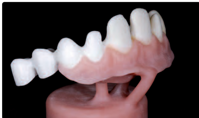
Restauration mit gepressten Gingiva Anteilen aus IPS e.max ZirPress Gingiva nach dem Ausbetten.
