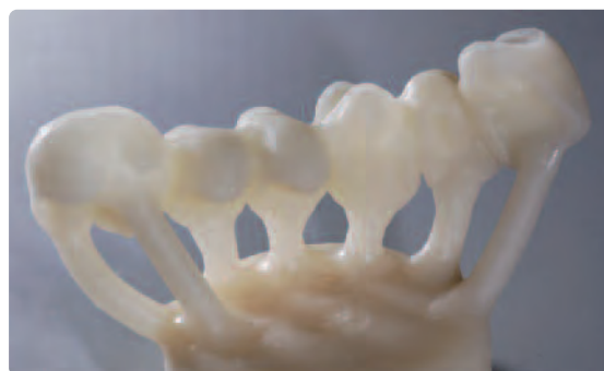
Grob- und Feinausbettung erfolgt mit Glanzstrahlperlen bei 4 bar Druck, bis die Objekte sichtbar sind. Feinausbettung bei 2 bar durchführen.
