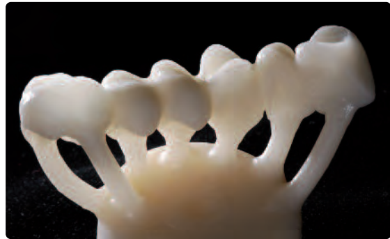
Entstandene Reaktionsschicht mit Invex entfernen und mit \text{Al}_2\text{O}_3 und 1–2 bar Druck sorgfältig reinigen.
