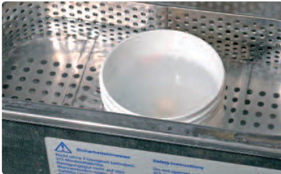
Entstandene Reaktionsschicht mit Invex entfernen und mit \text{Al}_2\text{O}_3 und 1–2 bar Druck sorgfältig reinigen.
