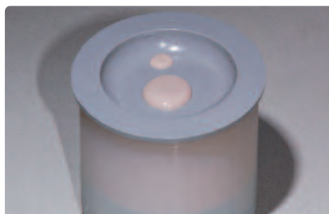
Eingebettete Muffel erschütterungsfrei abbinden lassen.
