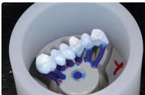
Zum Einbetten IPS Silikon Ring verwenden.
