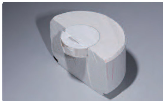
Muffelsystem 300g samt Einwegkolben mit einer Trennscheibe an der Markierung separieren. Beim Muffelsystem 100 g und 200 g Muffel an der Markierung auf Höhe des Alox Kolbens separieren.
