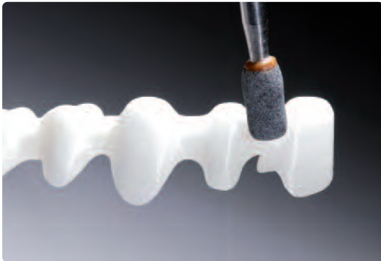
Erforderliche Nachbearbeitung mit speziell für \text{ZrO}_2 entwickelten Schleifkörpern durchführen.
