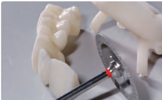
Presskanäle unter ständiger Befeuchtung mit einer dünnen Trennscheibe abtrennen.
