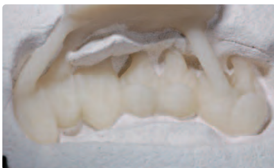
Grob- und Feinausbettung erfolgt mit Glanzstrahlperlen bei 4 bar Druck, bis die Objekte sichtbar sind. Feinausbettung bei 2 bar durchführen.
