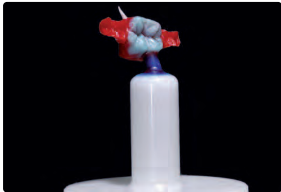
Modellation angestiftet mit einem Wachsdraht (ø 3 mm). Haltestift am ZirCAD Gerüst fixiert das Gerüst in der Einbettmasse.
