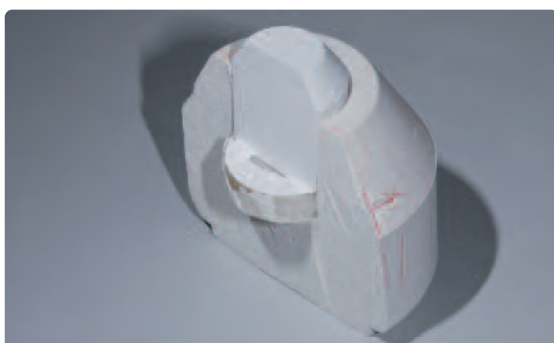
Muffelsystem 300g samt Einwegkolben mit einer Trennscheibe an der Markierung separieren. Beim Muffelsystem 100 g und 200 g Muffel an der Markierung auf Höhe des Alox Kolbens separieren.
