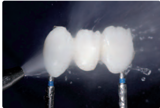
Abstrahlen der Restauration mit Al_2O_3 (Typ 100) mit 1,0 bar Druck. Vor dem Washbrand die Restauration mit dem Dampfstrahler gründlich reinigen und anschließend trocknen.
