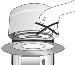
Der Ofenkopf besitzt einen elektrischen Antrieb und kann über die Elektronik bedient werden. Den Ofenkopf niemals von Hand öffnen, da das Getriebe beschädigt wird.
