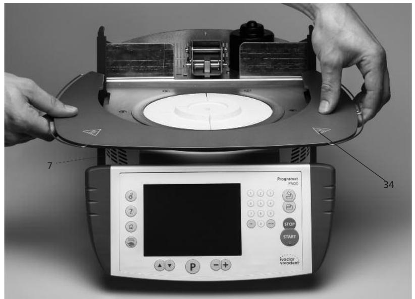
Sichern Sie nun die Brenngut-Ablageplatte (34) mit den zwei Befestigungsschrauben (35) inkl. der Silikonauflage (47).
