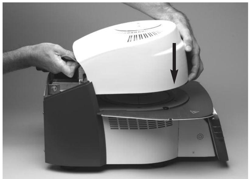
Achten Sie darauf, dass der Montagemarkierung-Ofenkopf (41) mit dem Montagemarkierung-Unterteil (42) übereinstimmt.
