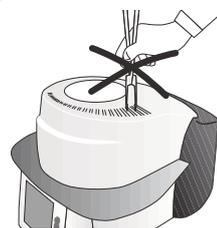
Führen Sie keine Gegenstände in die Lüftungsschlitze – Stromschlaggefahr!
