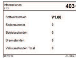
Die Informationsseiten von Seite 1 bis 3 geben Auskunft über die aktuelle Softwareversion, abgelaufene Betriebsstunden, Kalibrierungs-Einstellungen und Status der erkannten USB-Geräte wie Drucker und USB-Memory-Stick. Die Informationsanzeige dient also auch zur Kontrolle, ob ein USB-Gerät vom Programmat erkannt wurde.
