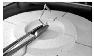
4. Gegebenenfalls mit der Brennzange in der Mitte des Kalibriersockels leicht andrücken, bis die Kalibrierprobe einrastet. Beachten Sie die Markierung.
